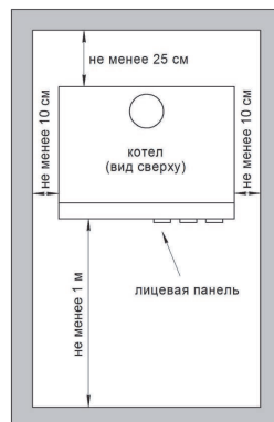
Рисунок 5 – Схема установки котла
